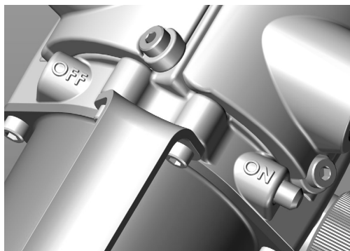
Pompe hors tension
